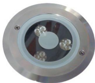
Apparecchio ad incasso in acciaio Inox 316, cromato lucido. Per esterni, giardini o terrazze. Fornito con 9 LED da 1W, ottiche 15°, 25°, 40° e cavo H05RN-F 2x1,5 (mm<sup>2</sup>) L=2,80mt. Nella versione RGB con cavo di alimentazione standard 14mt. Alimentazione 12V, gestione colore RGB e/o dimmer.
