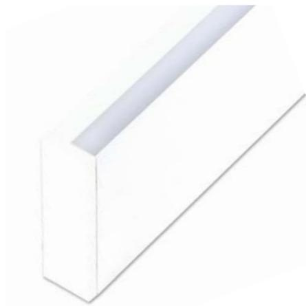
Profilo luminoso biemissione per installazione a plafone up and down. La base in estruso di alluminio bianco opaco assicura la corretta dissipazione del calore. I due diffusori opali sono retratti di 14mm rispetto al bordo. Particolarmente idoneo per sviluppare doppie linee luminose up and down. Alimentazione serie Trafo TC, centraline gestione colore e/o dimmer serie PRO o tramite App **FIBRECOM GO** (Android - IOS).
