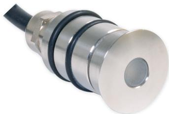
Segnapasso ad incasso in acciaio INOX AISI 316 satinato con vetrino opaco, per interni ed esterni. Fornito di un LED da 2W, vetrino effetto luce diffusa e cavo standard 50cm H05RNF. Alimentazione 24V, collegamento in parallelo, dimmerabile.
