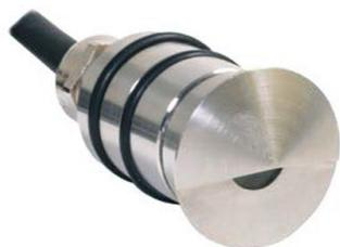
Segnapasso ad incasso in acciaio INOX AISI 316 satinato. Ghiera frontale con visiera per taglio di luce angolare 160° e vetrino opaco, per interni ed esterni. Fornito con LED da 2W, cavo standard H05RNF L=50cm. Alimentazione 24V, collegamento in parallelo, dimmerabile.
