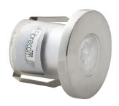
Corpo illuminante da incasso in policarbonato semitrasparente e frontale tondo in acciaio satinato. Per illuminazione da interni, cromoterapia, esterni e segnapasso. Fornito con un LED da 1.5W, ottiche 20° e 55°. Nella versione RGB è fornito con LED 3x1.5W, ottica 25°. Alimentazione 12/24V, collegamento in parallelo, gestione colore e/o dimmer.
