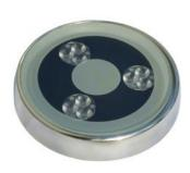
Corpo illuminante in acciaio INOX AISI 316, finitura lucida. Outdoor o immersione. Fornito con 9 LED da 1W, ottiche 15°, 25°, 40° e cavo H05RN-F 2X1 (mm2) L=2,80 m. Nella versione RGB con cavo di alimentazione standard 14mt. Alimentazione 12V, gestione colore RGB e/o dimmer.
