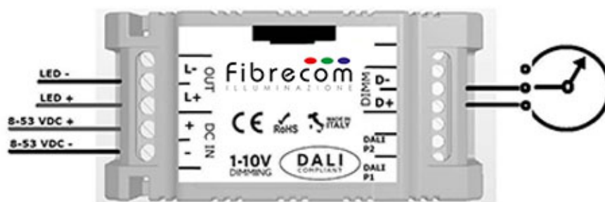
COLLEGAMENTO POTENZIOMETRO
