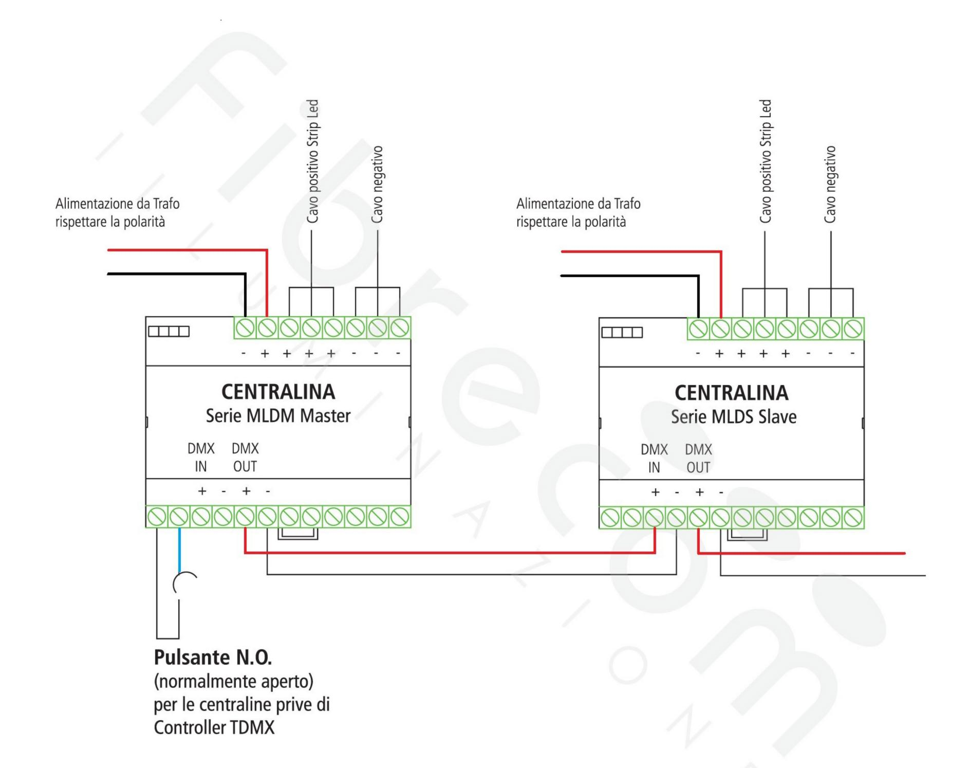
ATTENZIONE: Per il montaggio del solo Dimmer Master seguire lo stesso schema sopra riportato senza tener conto del collegamento con il Dimmer Slave.
